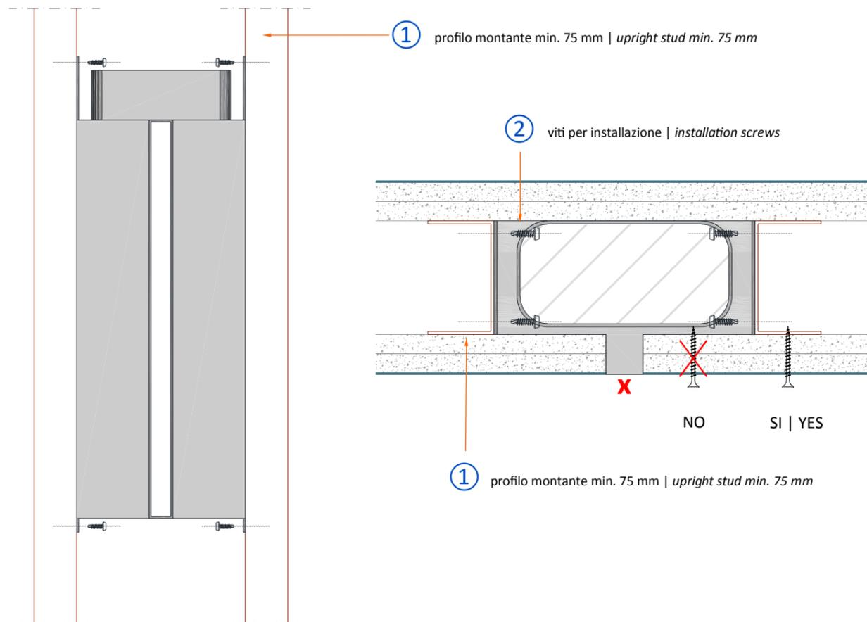
**Nota per l'installazione:** non usare schiume o colle per il fissaggio. Il diffusore deve poter essere regolato dallo stuccatore per avere il corretto punto di riferimento.
