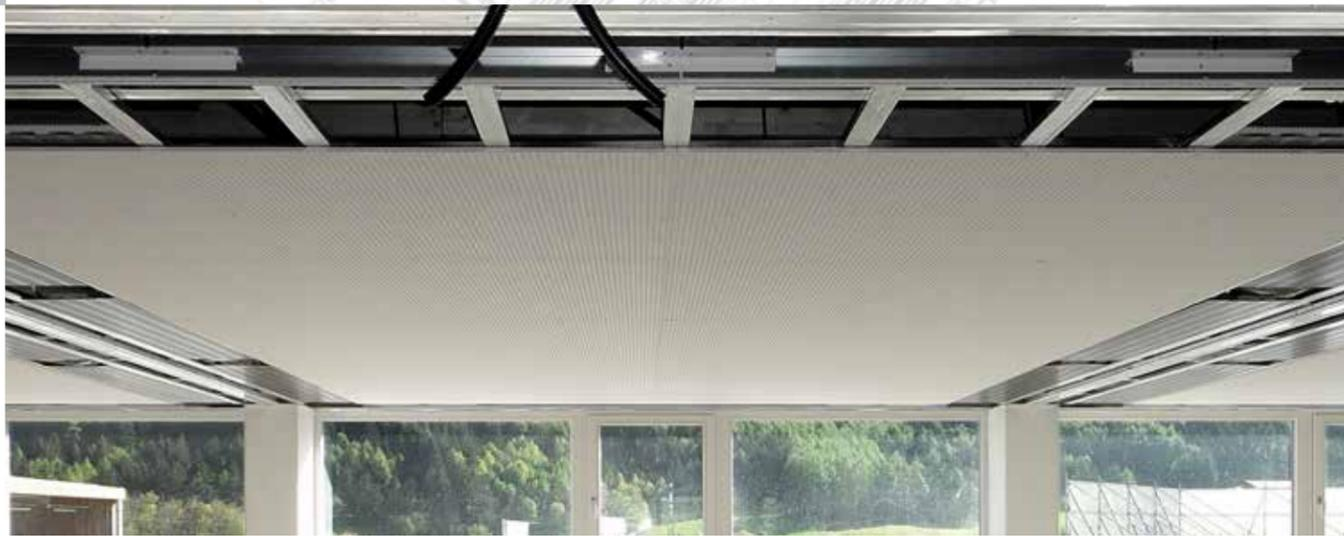
Valori riferiti ad un soffitto radiante GKM Acoustic rivestito con lastre in cartongesso con foratura regolare 6 mm, area aperta 9%, ribassato di 300 mm, con tessuto non tessuto sp. 0,27 mm d. 230 kg/m<sup>3</sup> e fibra poliestere coesionata sp. 30 mm d. 30 kg/m<sup>3</sup>.
